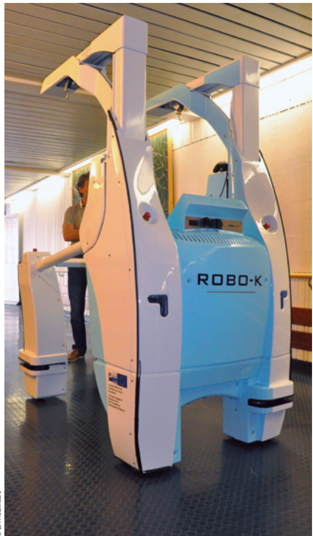
Le cobot mobile dédié à la rééducation de la marche conçu dans le cadre du projet ROBO-K.
