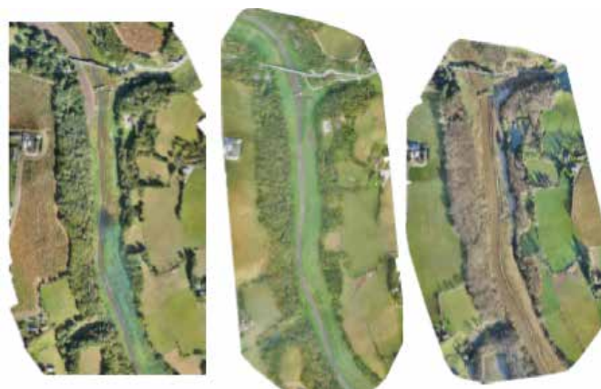
Figure 2 : suivi de l'évolution du tracé de cours d'eau, dans le cadre du projet sur la Sélune à l'amont de l'ancien barrage de Vezins, issu d'une série de prises d'images par drone en septembre 2020 par Plateforme D2T 5 .
